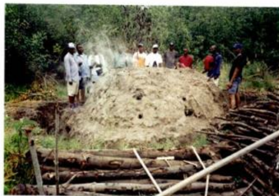
Photo 5 : Fours de carbonisation de palétuviers à l'île Bulambemba
