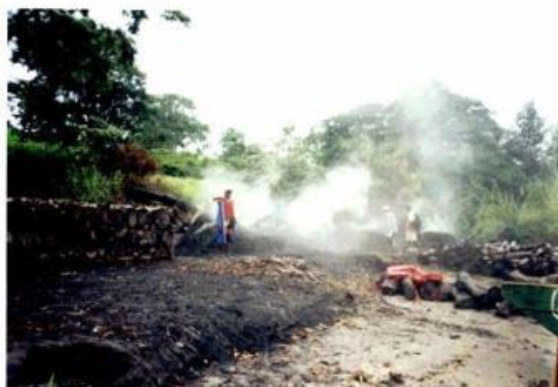
Photo 5 : Fours de carbonisation de palétuviers à l'île Bulambemba
